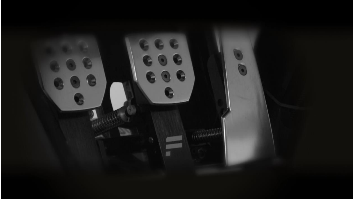
Abbildung 6: Die drei Pedale in Nahaufnahme. Alle drei Pedale weisen eine andere Mechanik auf, um das tatsächliche Empfinden der realen Fahrzeugpedale zu simulieren. Während das Gaspedal stufenlos (kontrolliert) zu betätigen ist, weist das Bremspedal eine zunehmende Dämpfung bei zunehmendem Druck auf. Das Kupplungspedal verfügt über eine spezielle Mechanik, welche das „Kupplungsgefühl“ über eine Übersetzung nachahmt.
