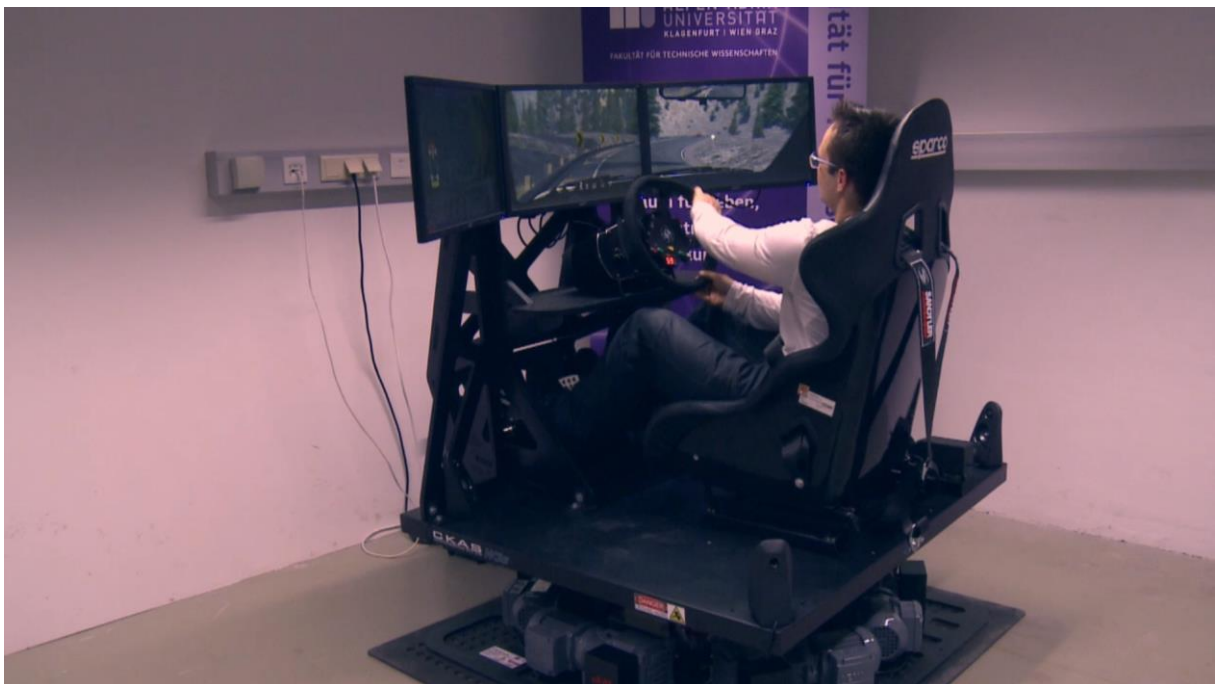
Abbildung 3: Der Fahrsimulator mit Testperson und aktiver Rennsimulation von schräg hinter der Plattform. Am Boden lassen sich die elektrischen Motoren erkennen. Die Plattform befindet sich in diesem Augenblick gerade in Neutralstellung.
