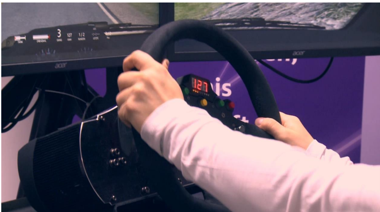
Abbildung 5: Nahaufnahme des Sportlenkrades, welches bedingt durch die Software eine Kraft an die Hände des Fahrers bzw. der Fahrerin zurück gibt und über eine digitale (LCD-) Geschwindigkeitsanzeige verfügt (Force-Feedback).
