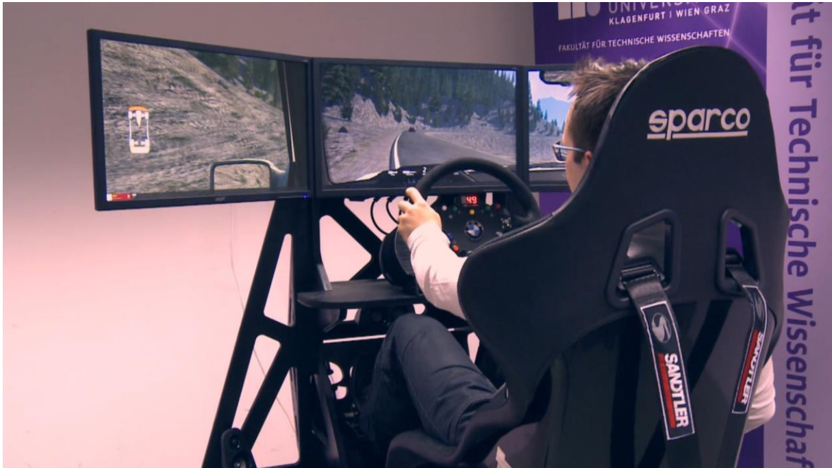
Abbildung 2: Der Fahrsimulator mit Testperson bei aktiver Rennsimulation. Ansicht von schräg hinter der Plattform. Im Vordergrund zu sehen ist der Sportschalensitz mit integriertem H-Gurtsystem.
