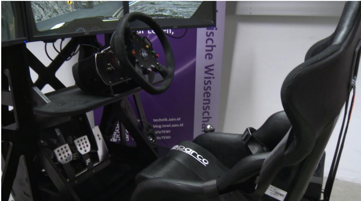
Abbildung 4: Nahaufnahme des Innenlebens des Fahrsimulatorcockpits. Zu sehen sind neben dem Schalensitz und den daran befestigten Gurten das elektro-mechanische Sportlenkrad, die drei Pedale, sowie der Schalthebel, welcher versteckt hinter dem Sitz hervorragt.
